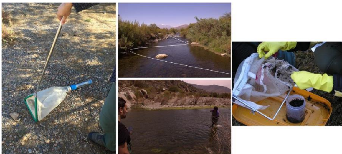
Figura 37: imágenes referenciales sobre el muestreo de macroinvertebrados bentónicos: Izq.: Red de muestreo (kicknet); centro: patrón de muestreo en zigzag, persona realizando la colecta con el Kicknet; der.: envasado.
