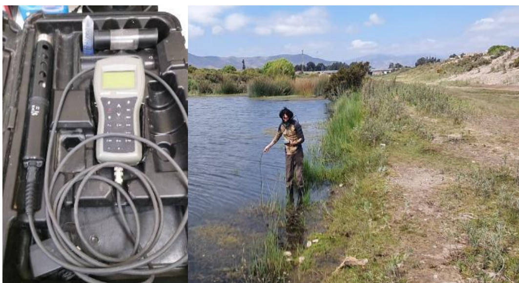
Figura 33. Equipo multiparámetro portátil marca Hanna HI9828 con su sonda, y su utilización en el muestreo
