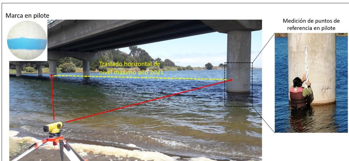
Figura 2-2 Medición topográfica y traslado de puntos de referencia, a pilote del puente de Cáhuil
