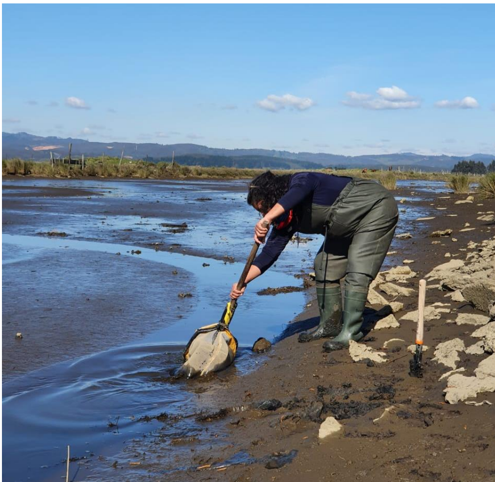
Foto 5. Red de pateo utilizada para la colección de macroinvertebrados bentónicos durante la campaña de monitoreo.
