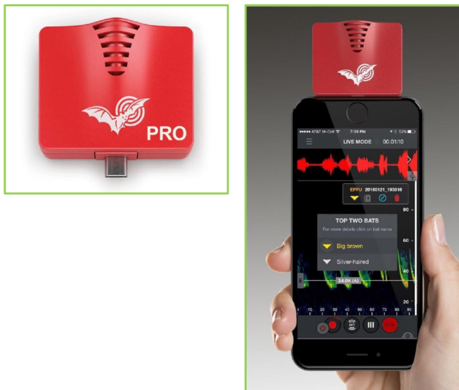
Figura 7. Equipo Echo Meter Touch Fuente: Wildlife Acoustics
