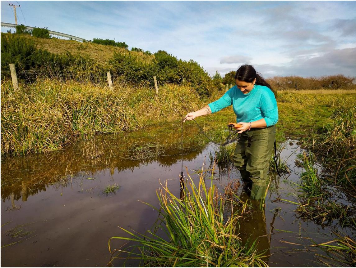
**Figura 2.** Toma de muestras de los parámetros de calidad de agua mediante sonda multiparamétrica.
