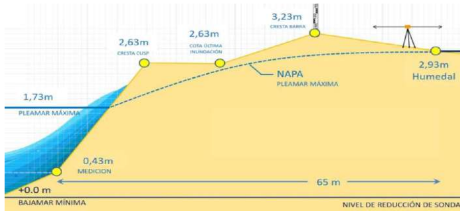
Figura 39: Topografía de la barra de arena de la desembocadura del río Elqui, referida al Nivel de Reducción de Sonda del Puerto de Coquimbo. Fuente: Elaboración propia.
