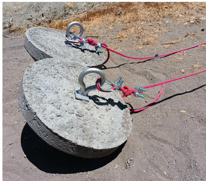
Figura 19 Anclajes de hormigón
