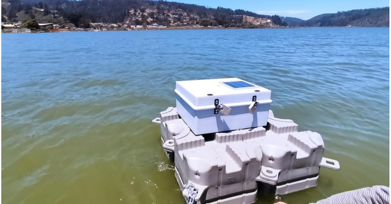
Figura 20 Boya de monitoreo instalada en el Humedal de Cáhuil
