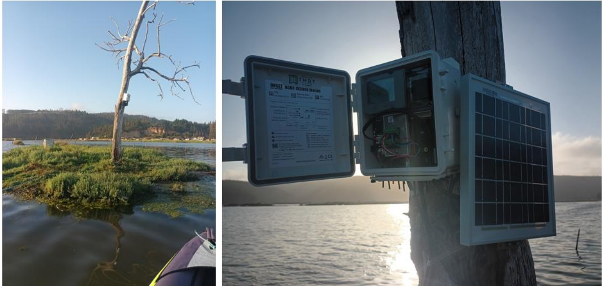
Figura 11 Sitio de monitoreo en sector Barrancas. Detalle del datalogger y panel solar instalado en el árbol
