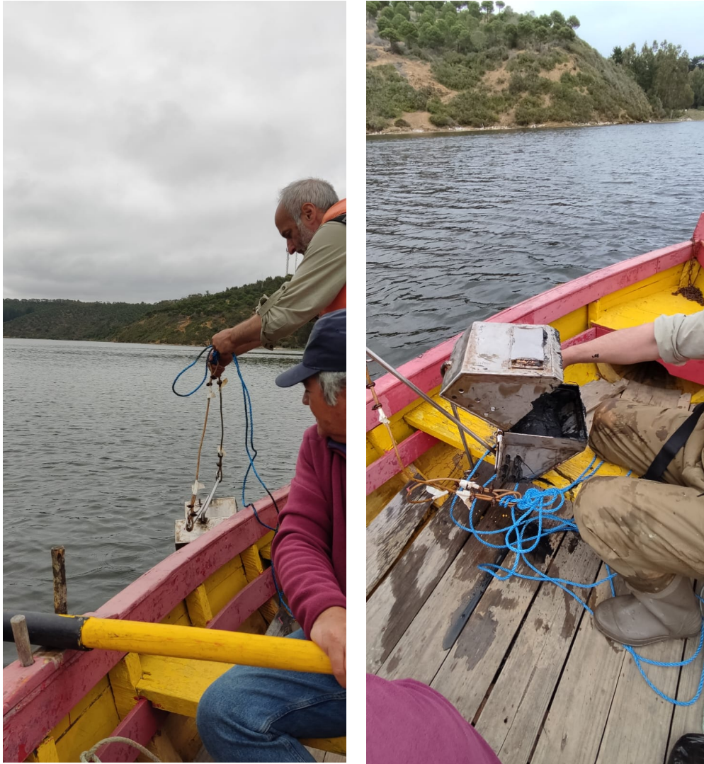
Figura 6: Toma de muestras con draga Van Veen.
