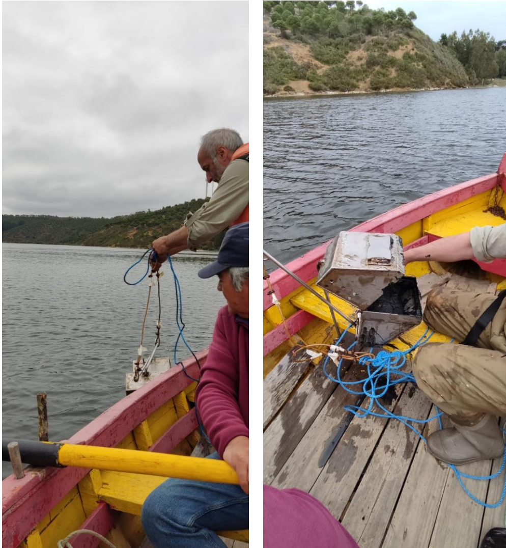
Figura 3: Toma de muestras con draga Van Veen.
