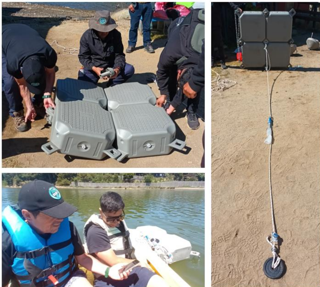
Figura 5 Instalación de boya de monitoreo OD y Temperatura
