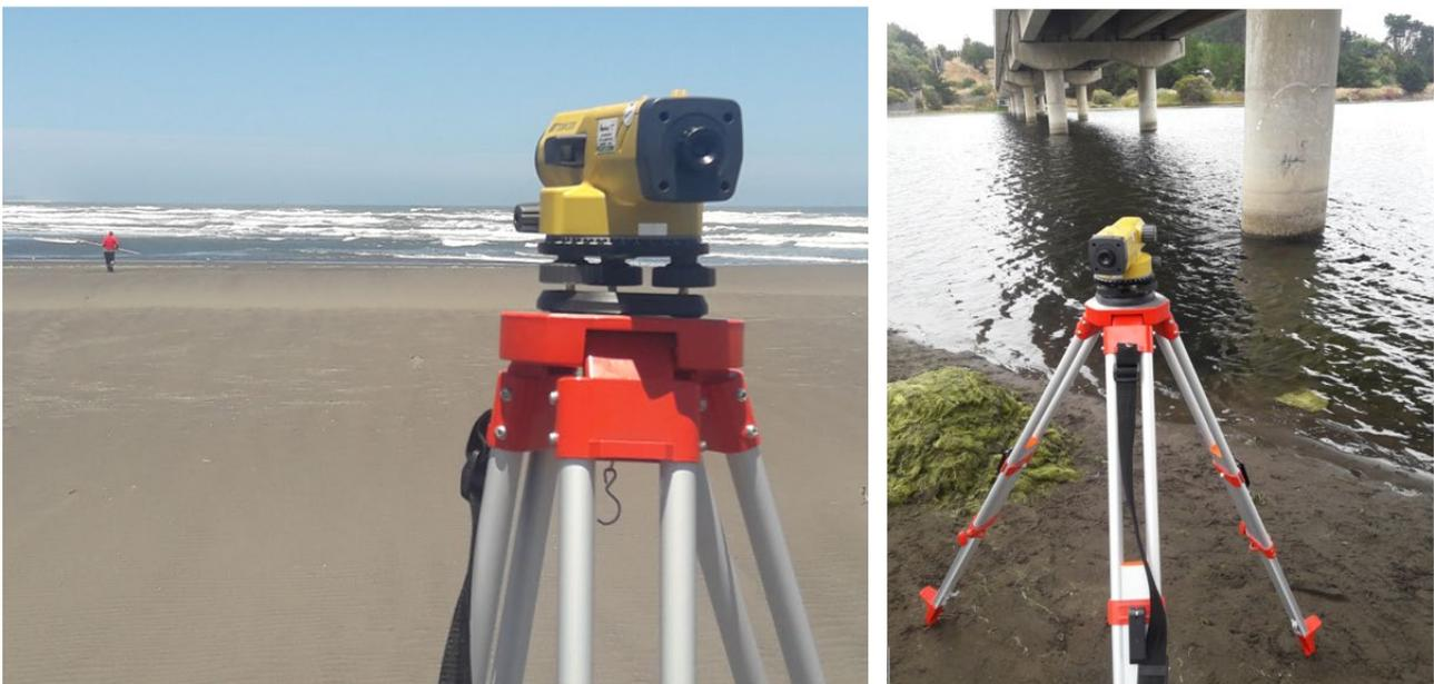
**Figura 25.** Uso de nivel topográfico para verificar diferencia de alturas entre puntos de interés
